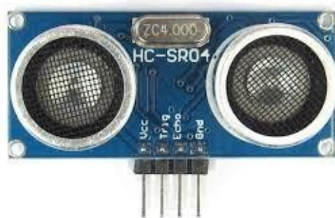
Рисунок 2.4 - Умовне позначення ультразвукового датчика HC-SR04 на графічній схемі.
