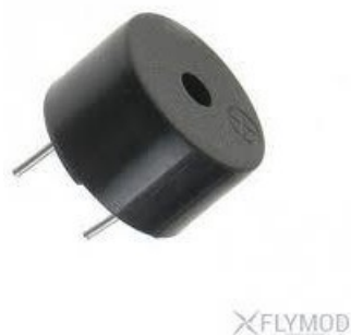
Рисунок 2.7 – Зовнішній вигляд пасивного зумера.
