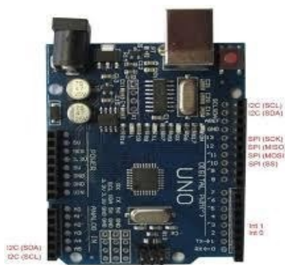
Рисунок 2.1 – Умовне графічне позначення Arduino Uno R3
