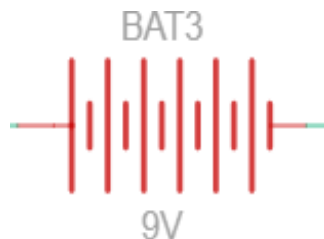
Рисунок 2.12 - Умовне графічне позначення джерела живлення на схемі.
