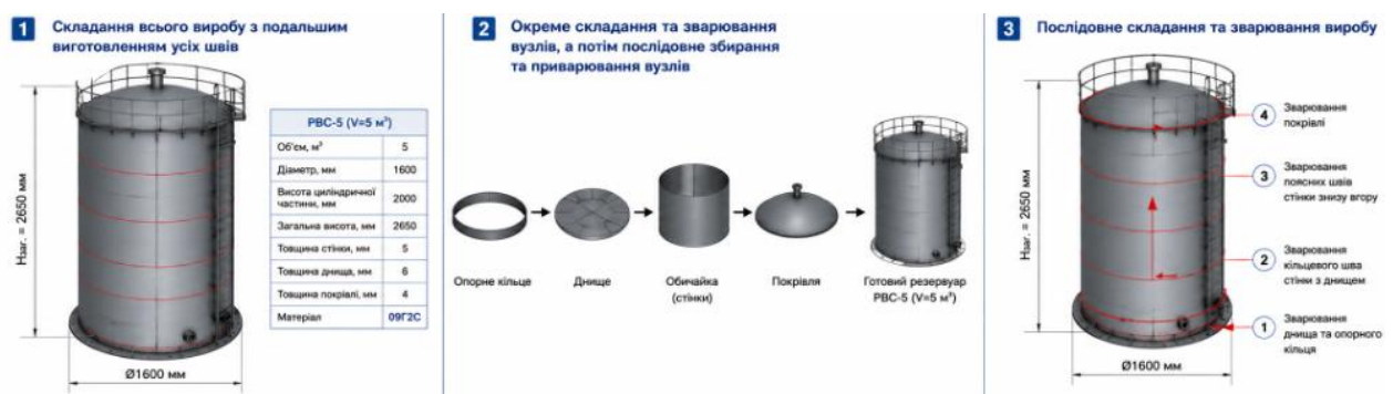
Рисунок 2.15 – Прслідовність складання та зварювання вертикального резервуара RBC-5
