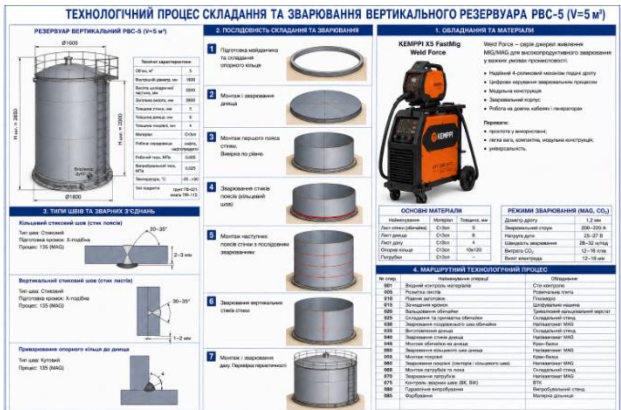
Рисунок 2.10 – Технологічний процес зварювання вертикального
