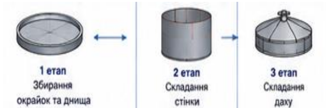
Рисунок 2.14 – Етапи складання резервуару
