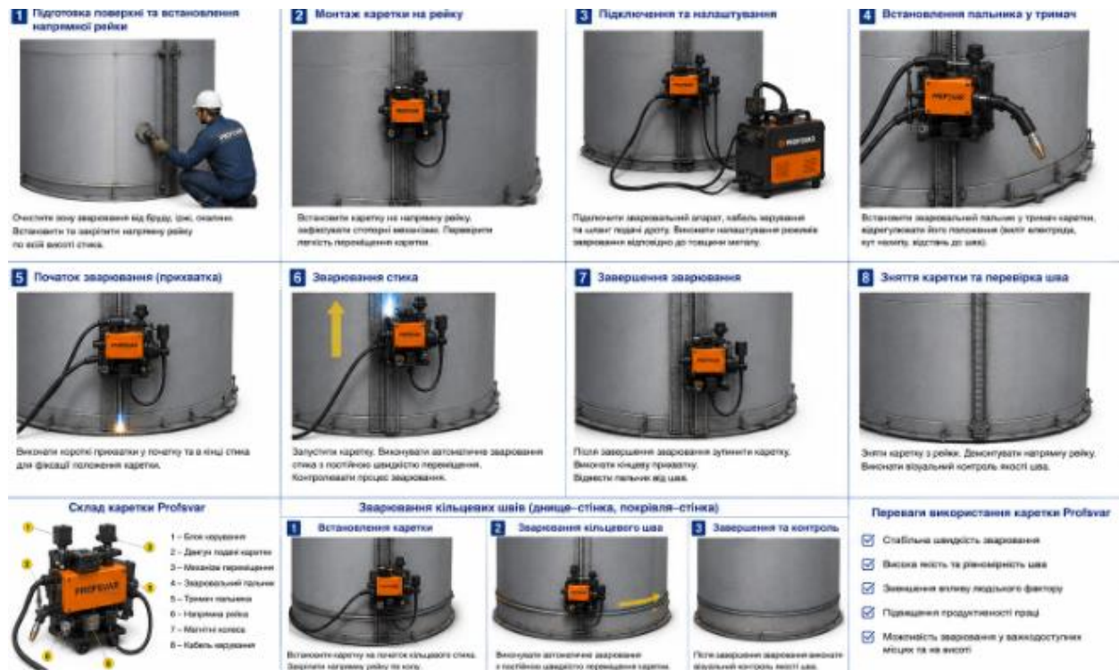
Рисунок 2.13 – Послідовність виконання робіт з використанням каретки Profsva
