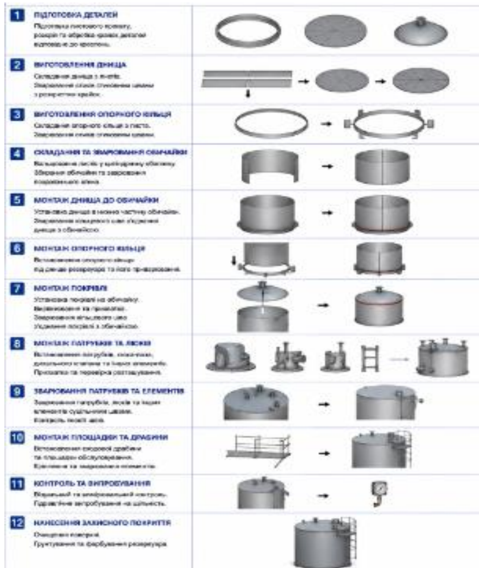
Рисунок 2.16 – Технологічна схема виготовлення зварної конструкції
