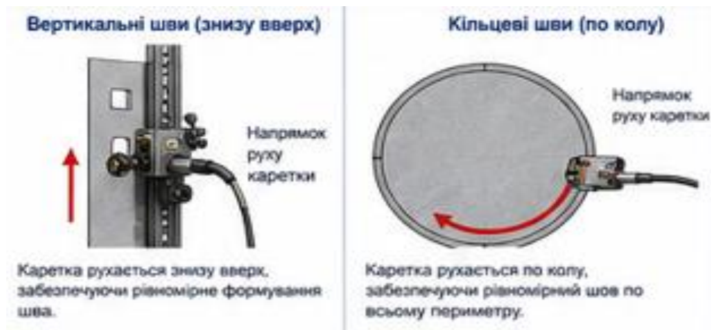
Рисунок 2.12 – Схема руху каретки Profsvar
