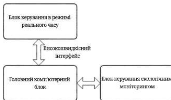
Рис. 1.1. Принципова схема системи управління автономним роботом для збирання яєць
