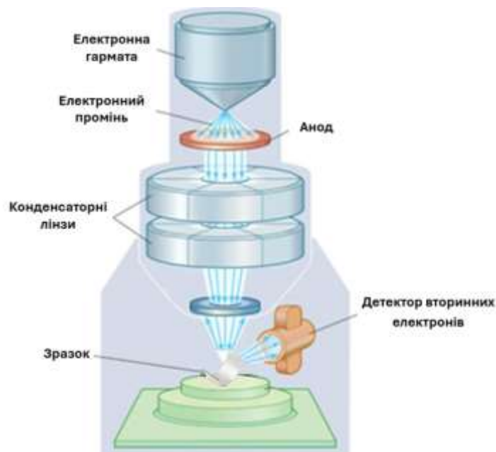
Рис. 2.13. Схема скануючого електронного мікроскопа (СЕМ)
