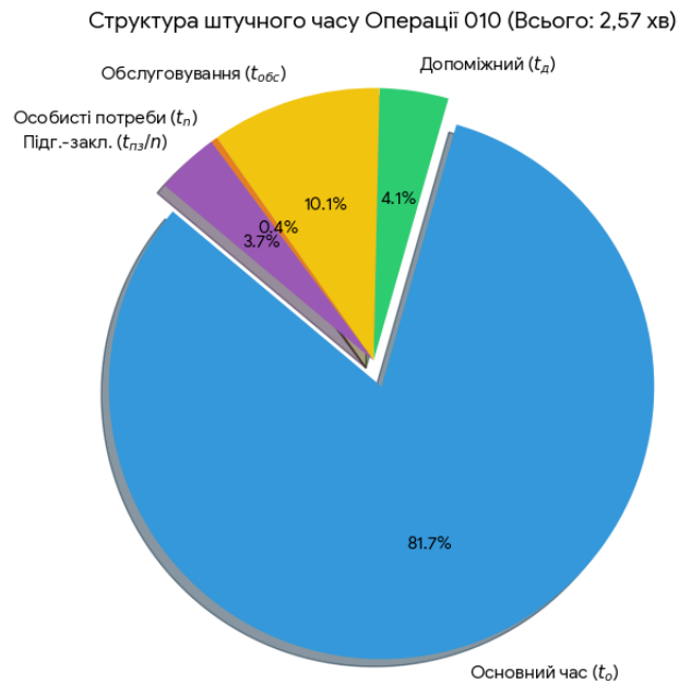
Рисунок 2.11 -Структура штучного часу для операції 010
