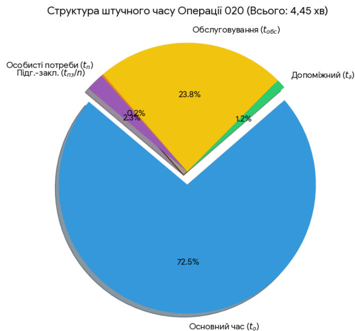
Рисунок 2.11 -Структура штучного часу для операції 020
