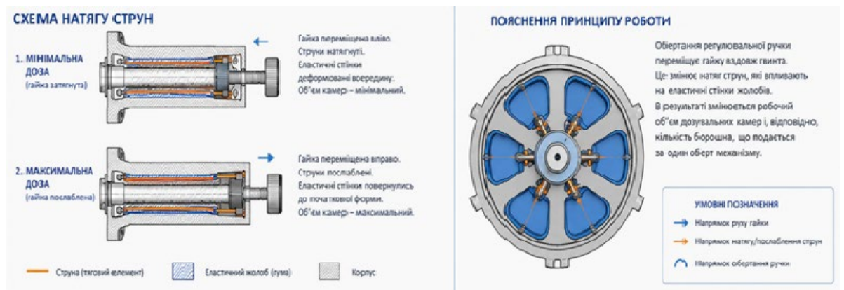
Рис. 2.4. Схема натягу струн та принцип роботи регулювального механізму
