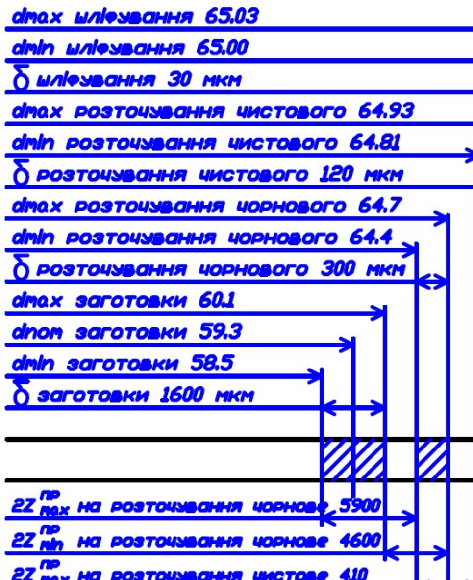
Рисунок 3.2.– Схема графічного розміщення припусків і допусків на обробку отвору \varnothing 65H7(+0.03) шестерні
