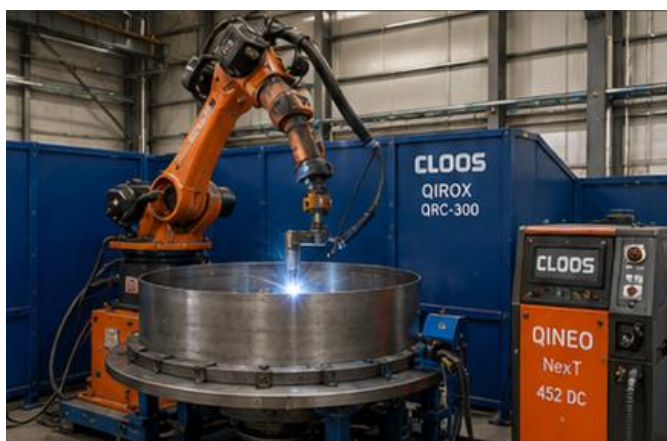
Рис. 2.10. — MAG-зварювання стику комплексом CLOOS QIROX QRC-300 + CLOOS QINEO NexT 452 DC [26]
