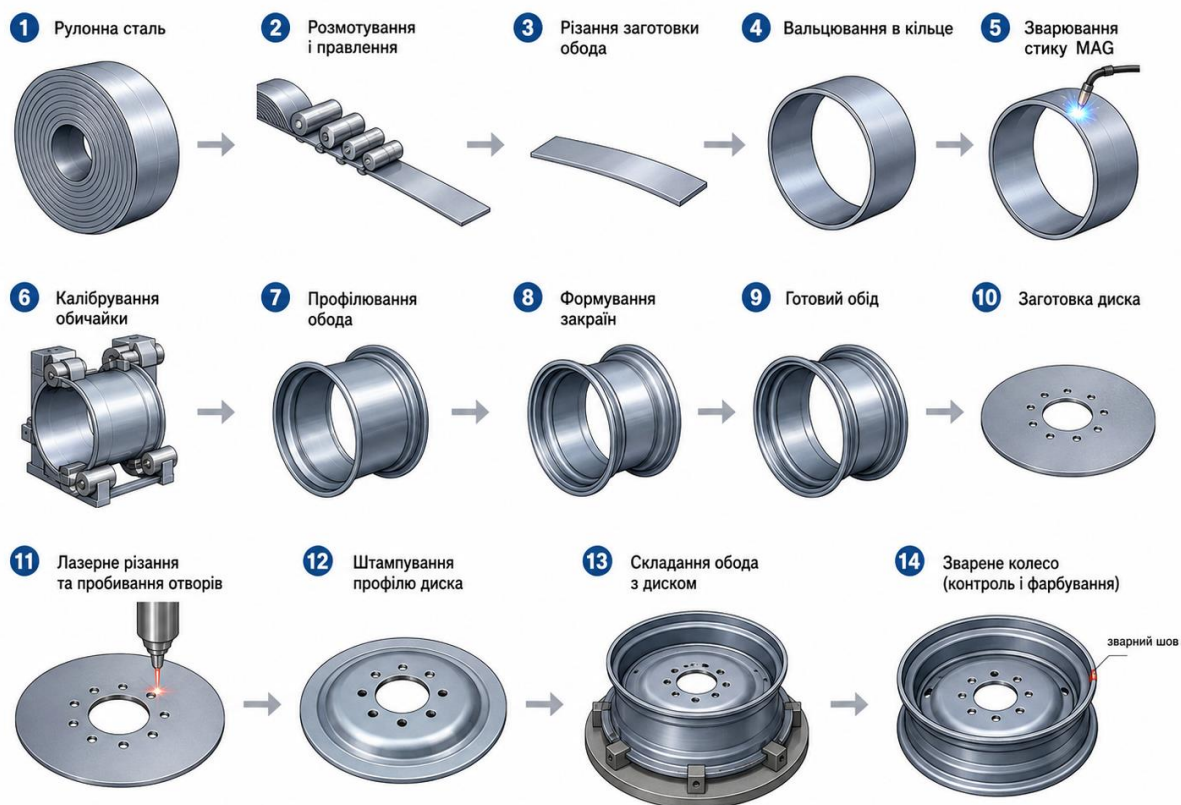
Рис. 2.3. — Маршрутна карта виготовлення колеса
