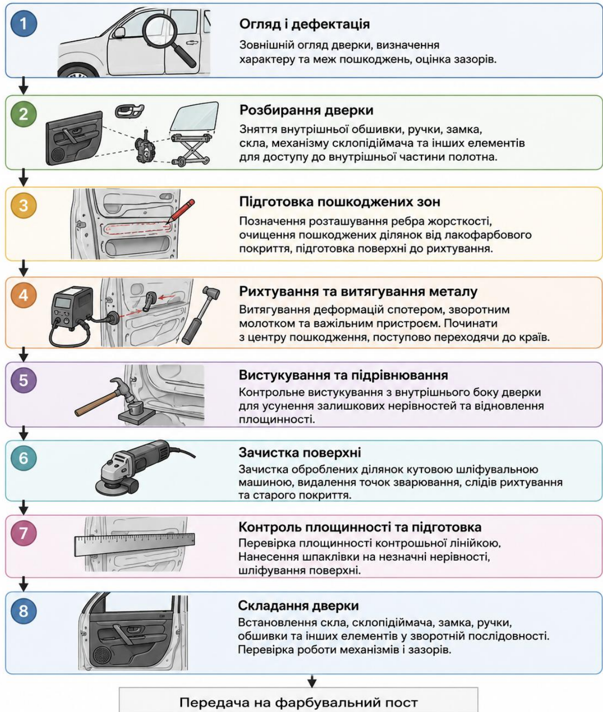
Рисунок 1.5 – Загальна послідовність ремонту передньої дверки.
