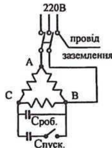
Рис.4. Схема включения трифазного асинхронного двигателя в однофазную сеть.
