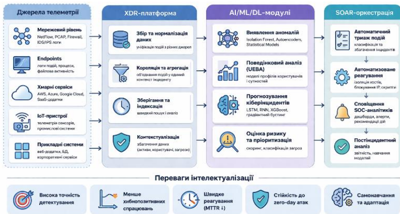
Рис. 1. Архітектура інтелектуальної системи аналізу та прогнозування кіберінцидентів у корпоративних мережах
