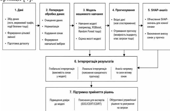
Рис. 1. Блок-схема застосування SHAP-аналізу в задачах прогнозування
