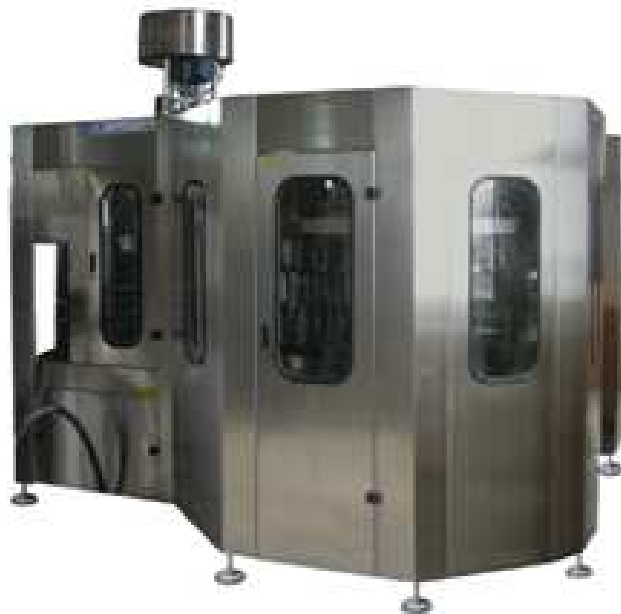
Рисунок 1.2 - Триблок для розливу газованих рідин компанії «Стандарт Плюс»
