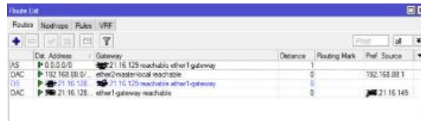
Рисунок 3.6 — Створення статичного маршруту за замовчуванням (Default Route)
