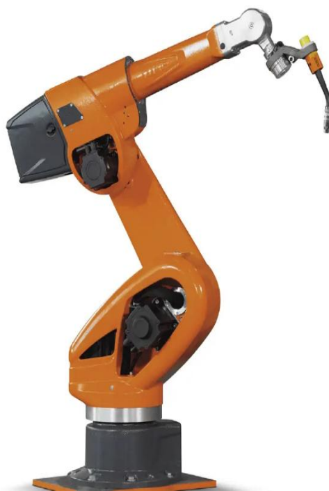
Рис. 2.1 Робот CLOOS QIROX QRC-350 для автоматичного MAG-зварювання [17]
