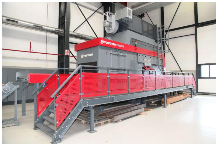
Рис. 2.9 Дробоструминна установка Voortman VSB [27]
