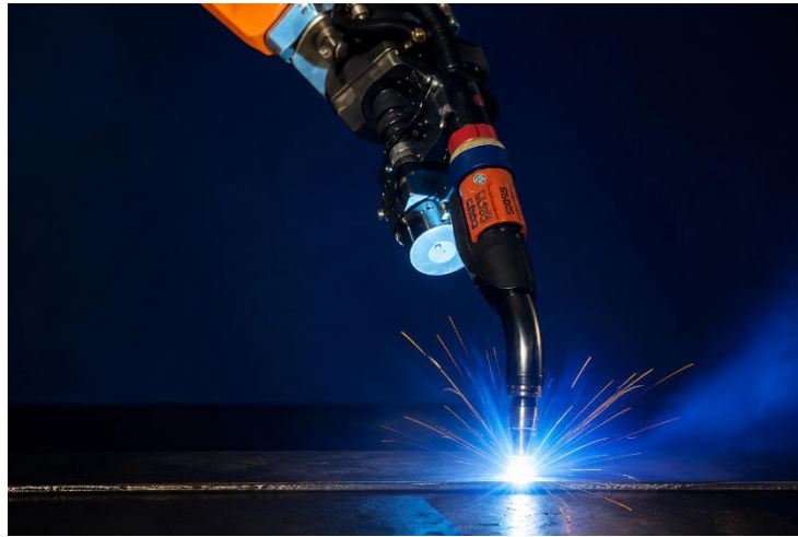
Рис. 2.3 Пальник CLOOS MIG/MAG robotic torch [17]
