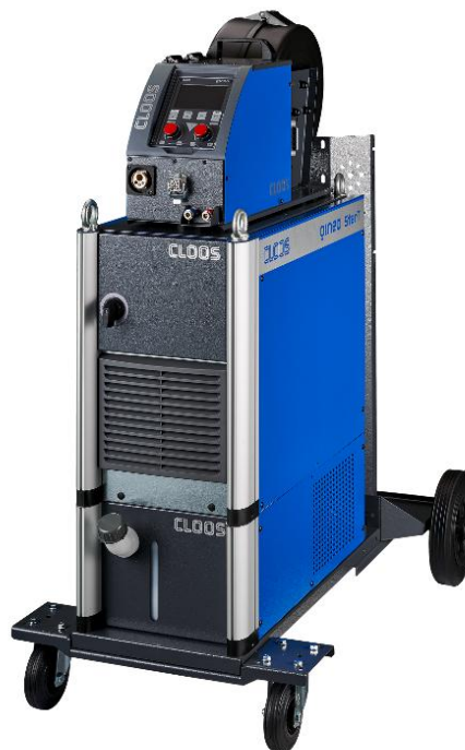
Рис.2.4 Напівавтоматичний зварювальний пост CLOOS QINEO StarT 502 [19]
