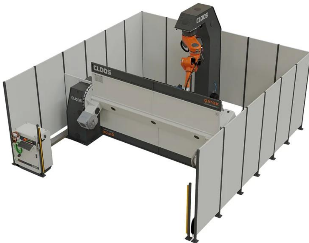
Рис. 2.1 Автоматизована зварювальна система CLOOS QIROX QR-CS-2-O-10kN Premium [17]
