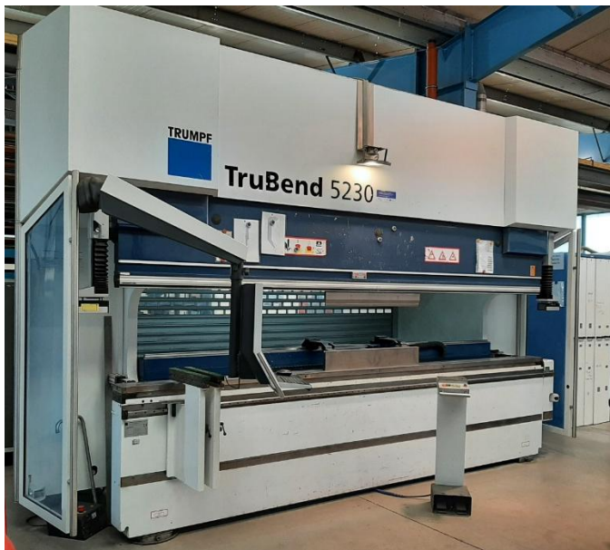
Рис. 2.10 Листозгинальний прес з ЧПК TRUMPF TruBend 5230 [26]
