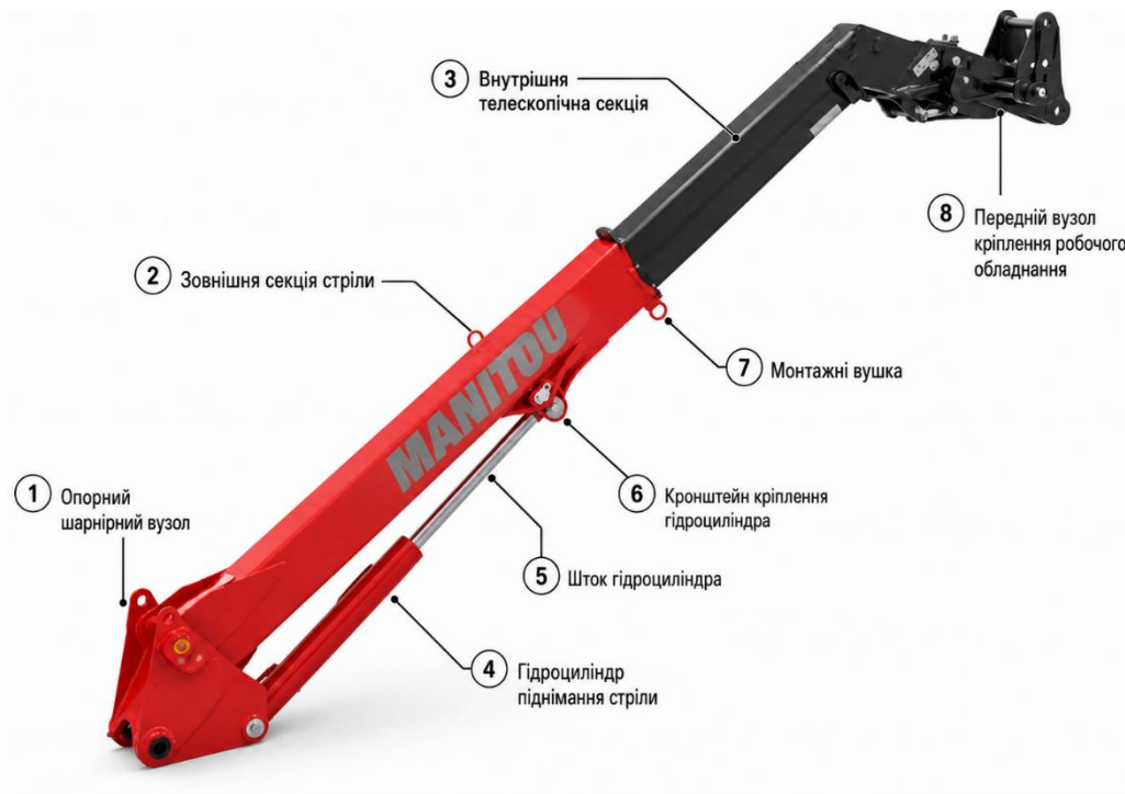
Рис. 1.2 Конструктивна схема стріли навантажувача МТ-Х 625 Н [2]
