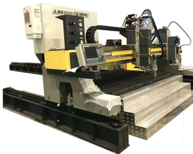
Рис. 2.6 – Загальний вигляд портальної установки плазмового різання з ЧПК, оснащеної плазмовою системою Kjellberg HiFocus [23]
