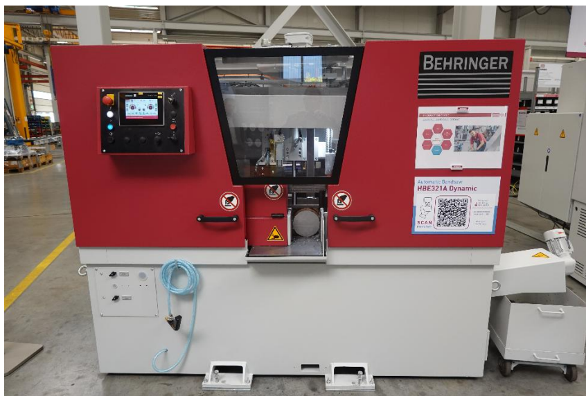
Рис. 2.7 – Автоматичний стрічковий верстат BEHRINGER HBE Dynamic [24]
