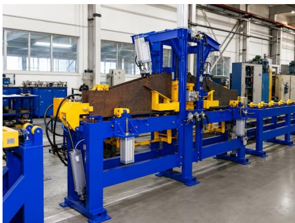
Рис. 3.5 – Кондуктор для складання шворневої балки (а) та поперечної (б) [26]
