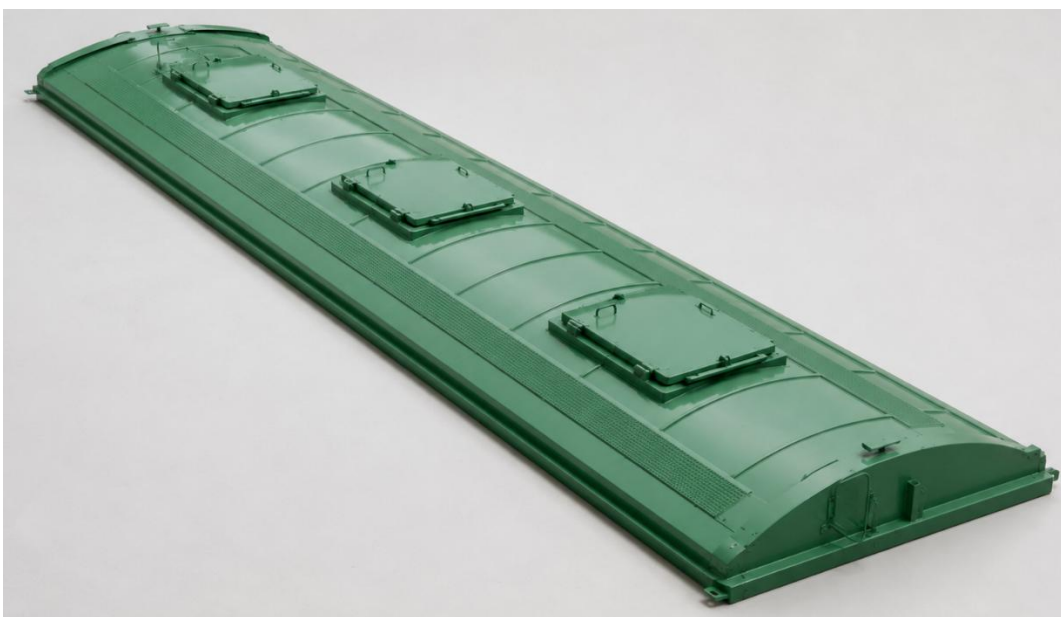
Рис. 1.2 Загальний вид даху комбінованого вагона 19-795-01
