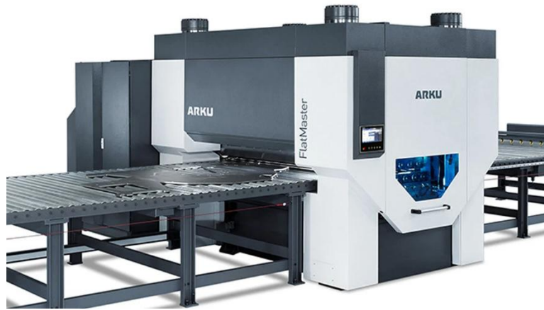
Рис. 2.4 Роликоправильна машина ARKU FlatMaster
