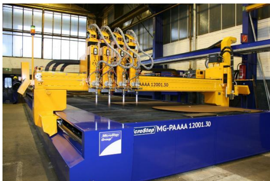
Рис. 2.8 – Портальна машина плазмового різання з ЧПК MicroStep MG для розкрою листового металу[26]
