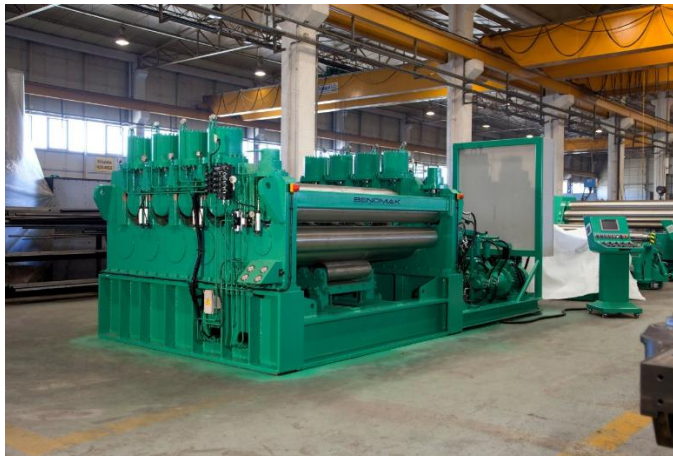
Рис. 2.7 Машина Bendmak BPSM для усунення хвилястості та залишкових деформацій листового прокату[25]
