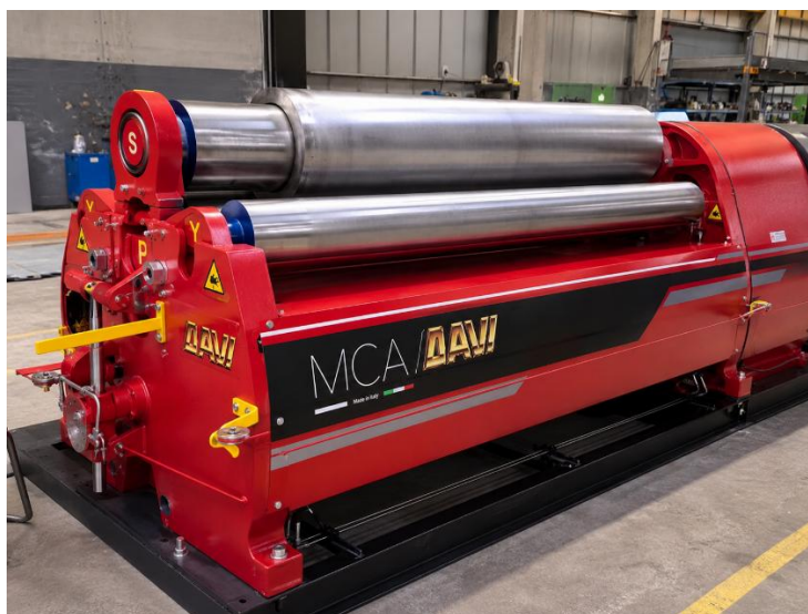
Рис. 2.11 – Машина DAVI MCA для вальцювання обичайок котла [30]
