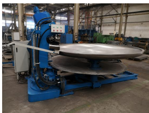
Рис. 2.12 – Машина ВФМ для формування та відбортювання кромek боковин цистерни [31]
