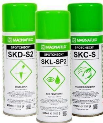
Рис. 2.7 Комплект Magnaflux SK-3 / Spotcheck Kit [26]
