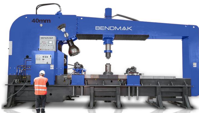
Рис. 2.12 – Машина ВФМ для формування та відбортювання кромek боковин цистерни [31]
