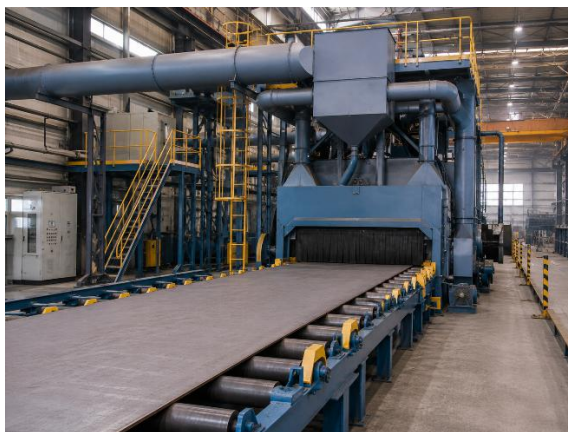
Рис. 2.8 – Дробоструминна лінія підготовки листового прокату [27]
