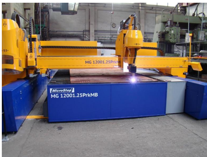
Рис. 2.10 – Портальна установка для розкрою листового металу [29]
