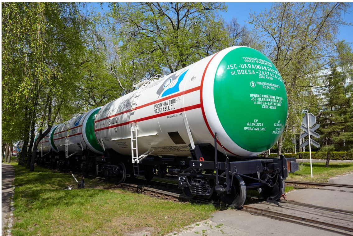
Рис. 1.1 – Загальний вигляд залізничної цистерни для перевезення світлих нафтопродуктів [2]
