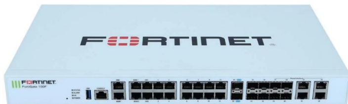
Рисунок 2.7 – Міжмережевий екран FortiGate FG-100F
