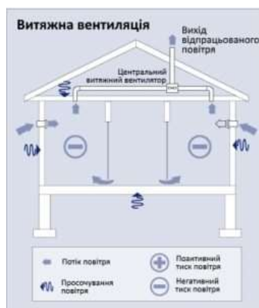
Рисунок 5.1 – Схема витяжної вентиляції
