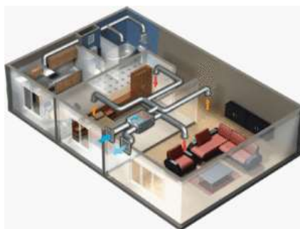
Рисунок 5.3 – Схема припливно-витяжної вентиляції
