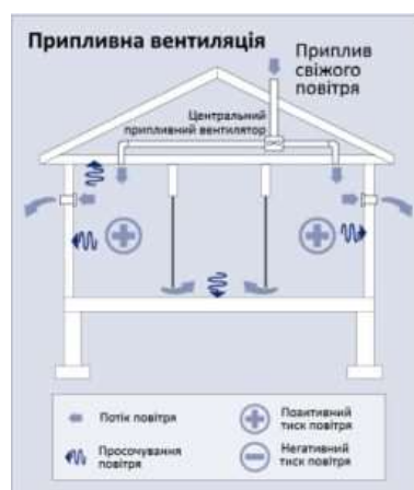
Рисунок 5.2 – Схема припливної вентиляції
