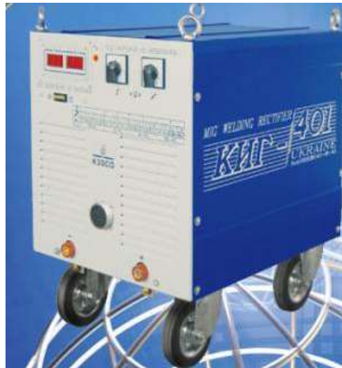
Рисунок 2.4 – Вигляд джерела живлення КІГ-401 (КЗЕЗУ) [7]
