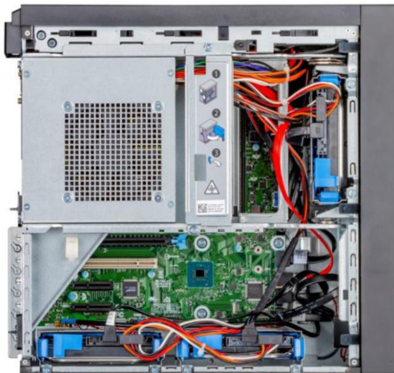
Рисунок 2.3 – Внутрішня будова сервера Dell PowerEdge T40
