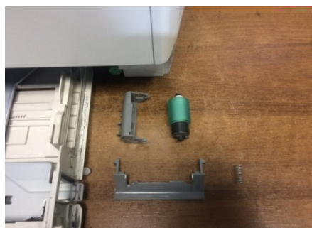
Рисунок 2.14 - Заміна гуми на розділювальному ролику
