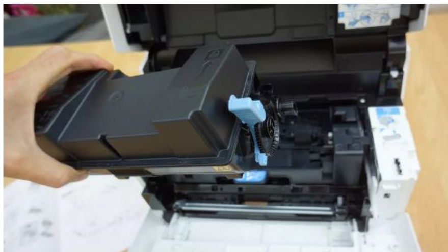
Рисунок 1.10 – Встановлення контейнера з тонером
