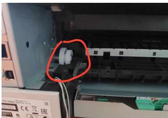
Рисунок 2.16 - Шестерні, пов'язані з приводним механізмом вала термофіксатора
