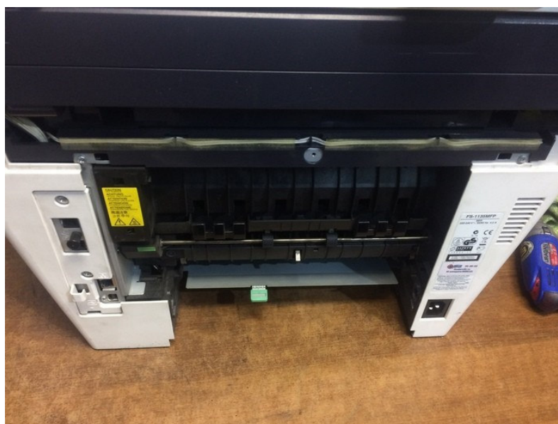
Рисунок 2.18 – Розбирання кришок принтера
