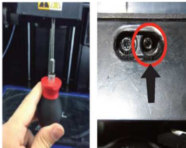
Рисунок 2.37 – Послаблення стопорного гвинта
