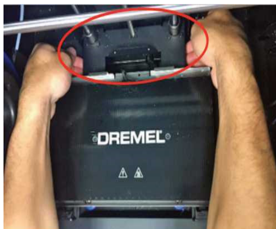
Рисунок 2.27 – Зняття скляної пластини
