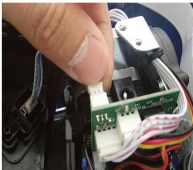
Рисунок 2.38 – Від'єднайте датчик від плати екструдера.
