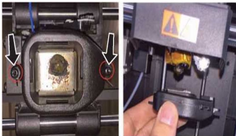
Рисунок 2.50 – Розбирання блоку дефлектора вентилятора
