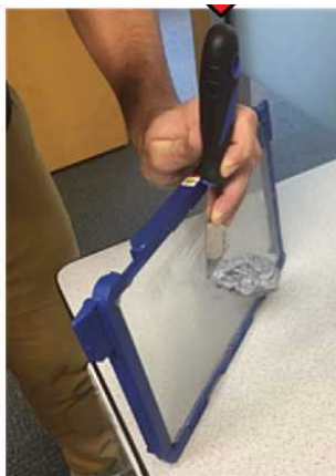
Рисунок 2.20 – Точка прикладання сили до інструменту для видалення об'єкта
