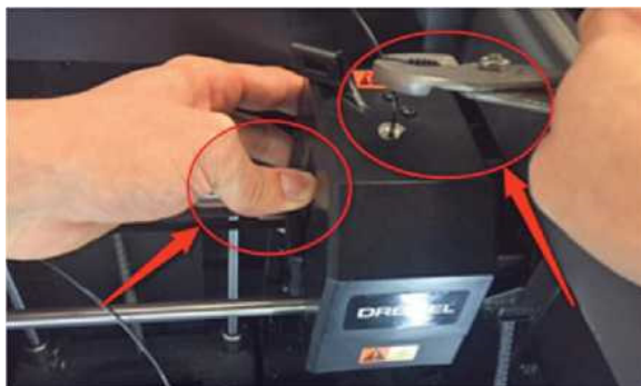
Рисунок 2.41 – Метод 3 для вилучення нитки: екструзія нитки
