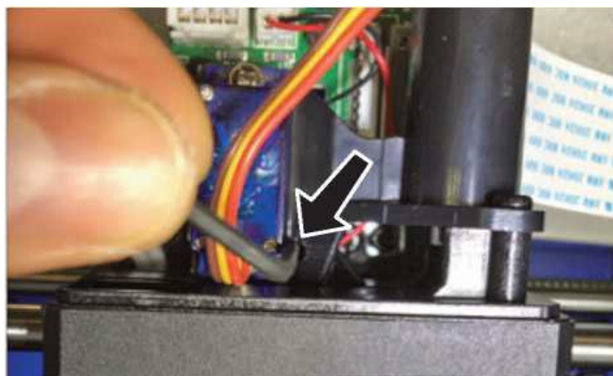
Рисунок 2.49 – Викрутіть стопорний гвинт.
