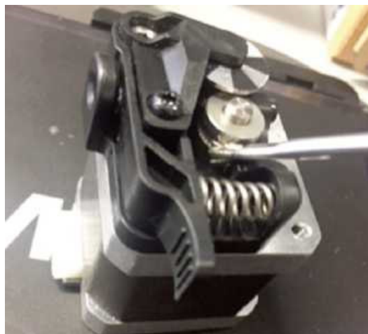
Рисунок 2.47 – Технічне обслуговування редуктора крокового двигуна
