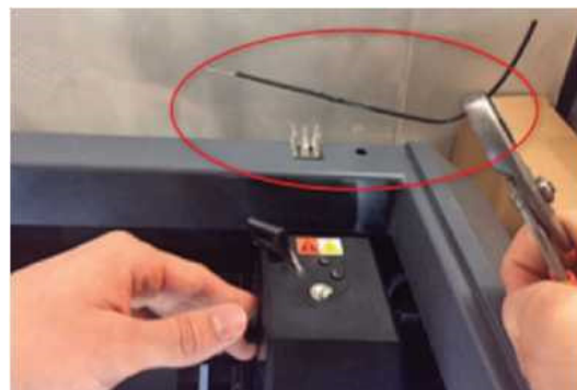
Рисунок 2.41 – Метод 3 для вилучення нитки: екструзія нитки
