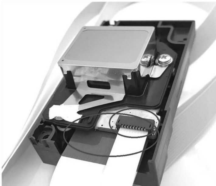
Рисунок 2.16 - Огляд кабелю і роз'ємів підключення головки
