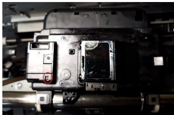
Рисунок 2.19 – Розташування датчика ширини паперу
