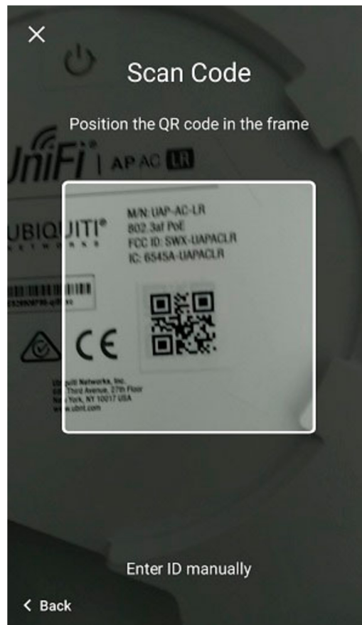
Рисунок 3.6 — Ідентифікація точки доступу шляхом сканування QR-коду
