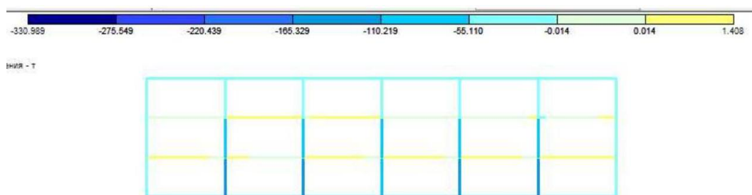
Рисунок 2.18 – Епюра зусиль у стрижневих елементах середньої рами
