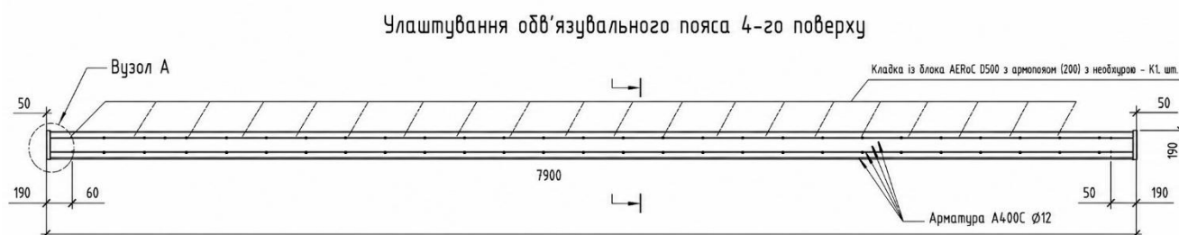
Рисунок 2.6 — Улаштування обв'язувального поясу над 4 поверхом
