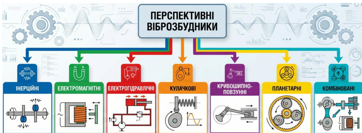
Рисунок 1. Загальна класифікація віброзбудників вібраційного технологічного обладнання
