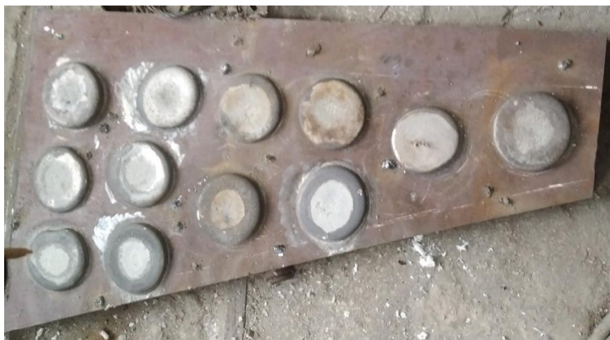
Рисунок 1. Наплавлена «шайбами» футеровка
