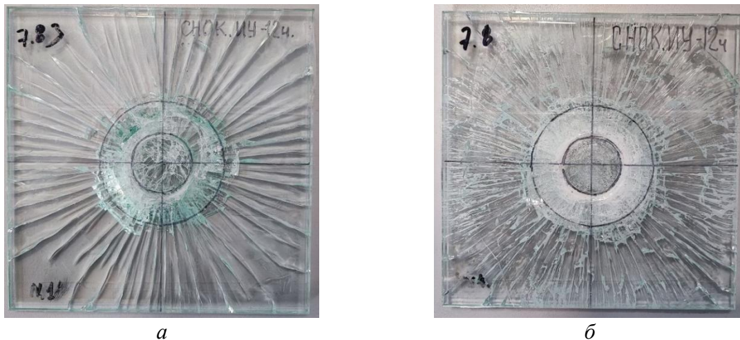
Рисунок 1 – Фотографії зруйнованих пластин флоат-скла з іонно-обмінним зміцненням протягом t = 12 годин: a – зразок № 11, \sigma = 206 МПа; b – зразок № 4, \sigma = 601 МПа.
