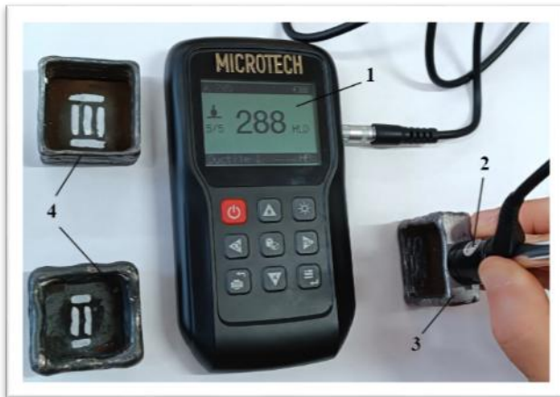
Рисунок 2 – Дослідження твердості матеріалу за допомогою твердоміра ТПУ-1
