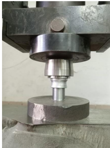
Рисунок 2 – Проведення випробувань сумарної міцності з'єднання сталевій втулки з кільцем з алюмінієвого сплаву
