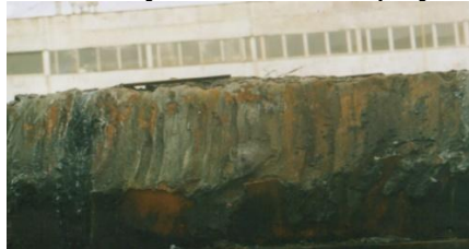
Рисунок 1 – Вигляд утилізаційного різі станини 630-тонного пресу
