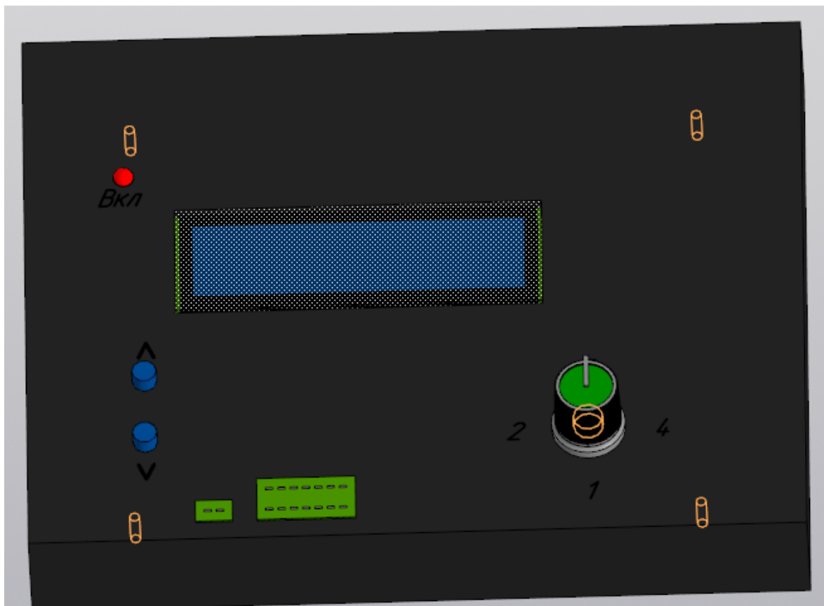
Рисунок Б.3 – 3D модель пристрою, верхня кришка
