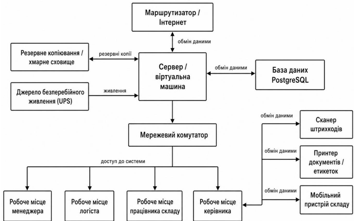
Рисунок 3.4 – Схема взаємодії апаратної частини комп'ютерної системи підтримки логістичної діяльності підприємства
