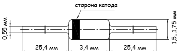
Рисунок 2.10 - Габаритні розміри стабілітрона 1N4750ATR
