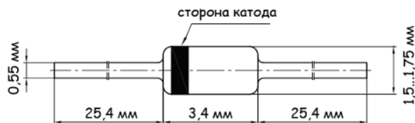
Рисунок 2.6 – Габаритні розміри діода 1N3181
