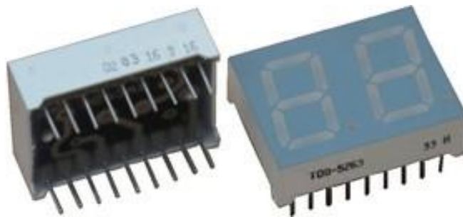
Рисунок 2.6 - Зовнішній вигляд індикатора DA56-11GWA "Kingbright"
