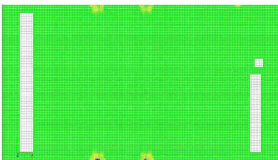
Рисунок 3.10 - Нижнє армування по X (крок 200 мм)
