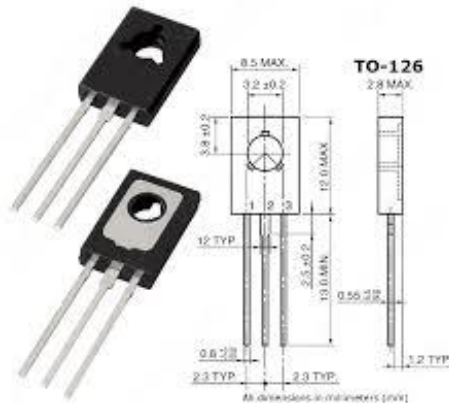
Рисунок 2.8 – Габаритні розміри транзистора BD136
