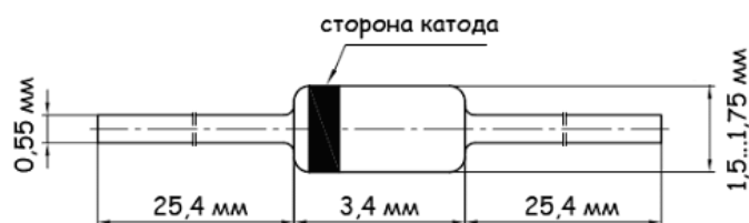
Рисунок 2.6 – Габаритні розміри діода BYW178-TR
