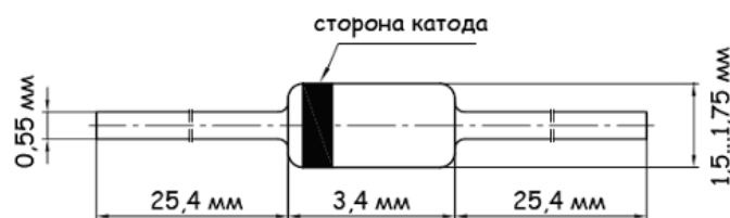
Рисунок 2.7 – Габаритні розміри діода SF38
