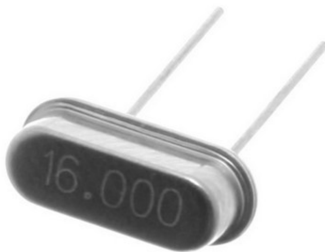
Рисунок 2.4 – Зовнішній вигляд та габаритні розміри кварцового резонатора
