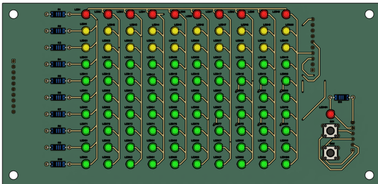
Рисунок А.3 – 3D модель світлодіодної матриці , вузол друкований
