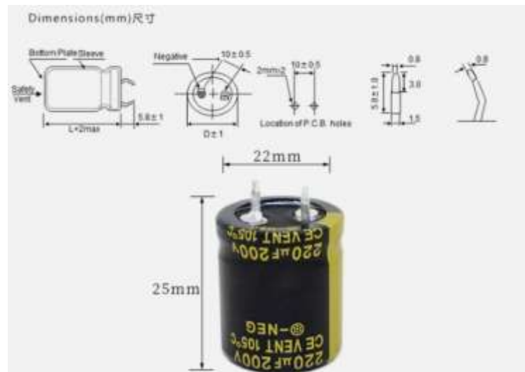
Рисунок 2.7 – Габаритні розміри електролітичного конденсатора SR Passives
