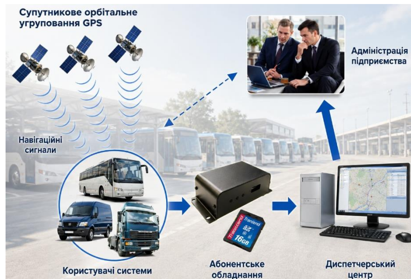
Рис. 1.1. – Принцип функціонування системи моніторингу ТЗ
