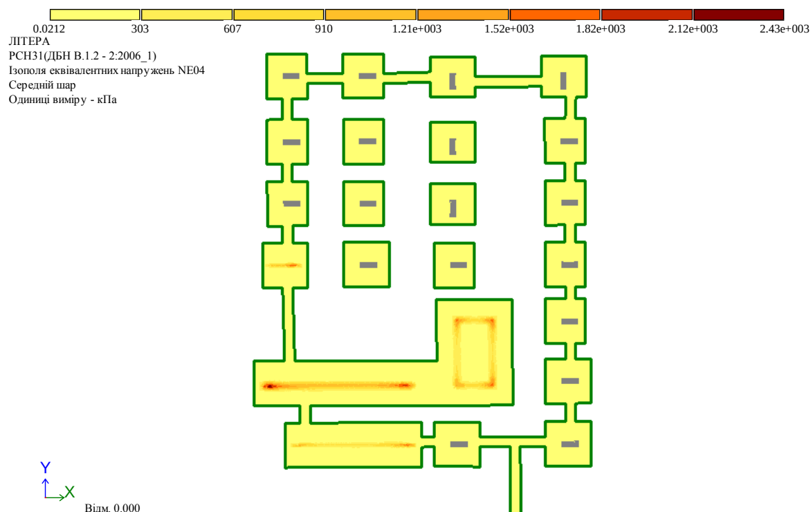
Рисунок 2.27 – Еквівалентні напруження в ростверку половини будівлі
