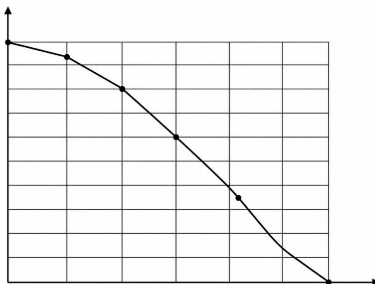
Рисунок 1.9 – Графік залежності імовірності безвідмовної роботи перетворювача напруги для побутової апаратури від часу [1]
