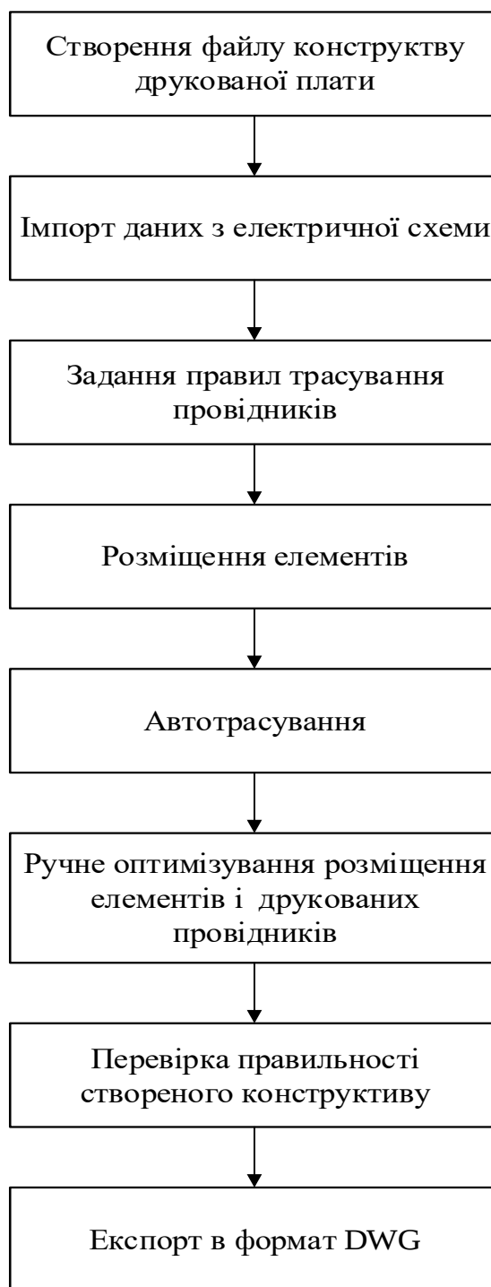
Рисунок 2.1 – Створення конструктиву друкованої плати в Altium Designer
